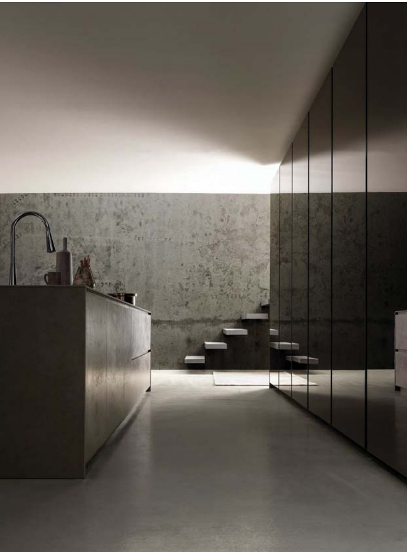
L'anta Blade in kerfite / Gres spessore 10 mm è realizzata con tre lastre di kerfite o gres incollate tra loro.
