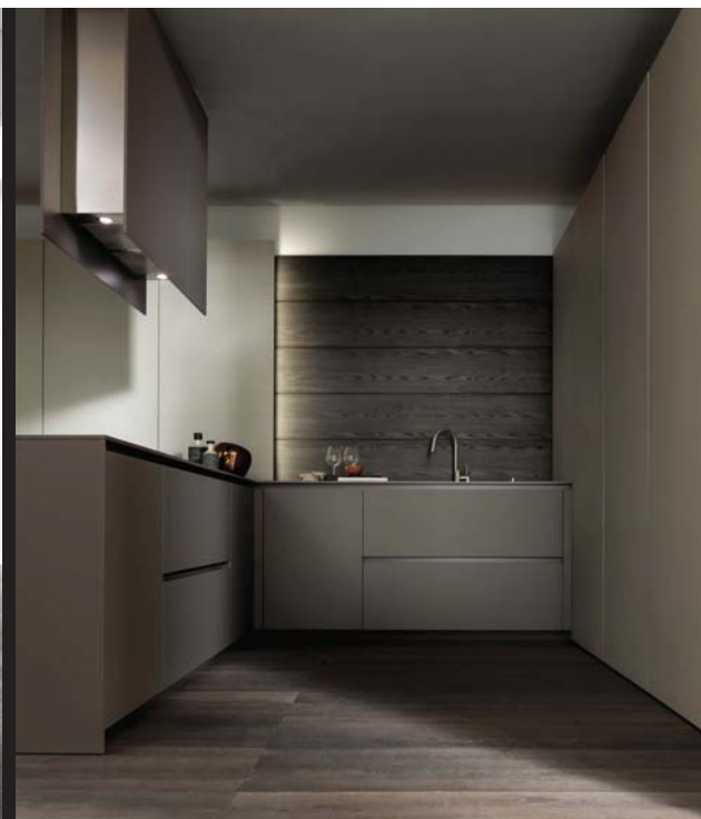
Colonne terra-soffitto (con altezze personalizzate da 240 fino a 270 cm) ed elementi in appoggio piano-soffitto, in finitura melaminica perla, senza zoccoli né maniglie (apertura push-pull) alternate ad ante sporgenti 15 cm per ricavare tra esse una nicchia che può essere rivestita con fianchi e schienali in melaminico Tivoli o altre finiture e dotata di illuminazione a Led dimmerabili.
